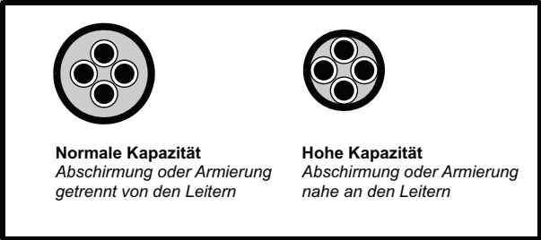
Abbildung 4-8 Einfluss der Kabelkonstruktion auf die Kapazität
