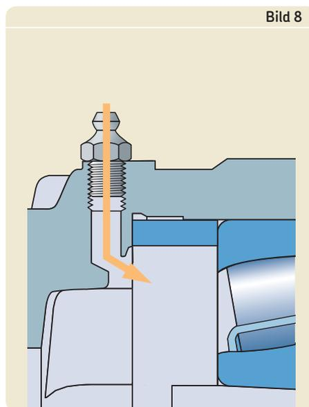
Gehäuse für Ölschmierung
