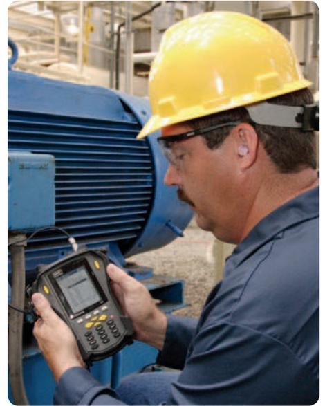
*Schwingungsmessung mit Hilfe des SKF Microlog Datensammlers/-analysators*
