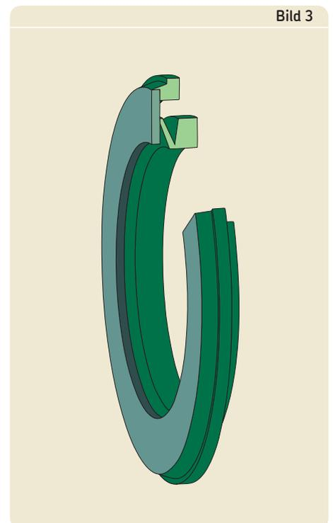
baufälle infrage, die schwierigen Betriebsbedingungen ausgesetzt sind, wie z.B. hohen Drehzahlen, oder bei denen die Wellen grob bearbeitet sind. Sie lassen hohe Umfangsgeschwindigkeiten zu, sollten jedoch bei Geschwindigkeiten über 7 m/s auf der Welle axial bzw. axial und radial abgestützt werden. Abmessungsempfehlungen für entsprechende Stützringe enthält die **Tabelle 3**.
